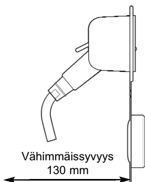
Fig 1 Tavallinen asennusasento Kulmapidike
